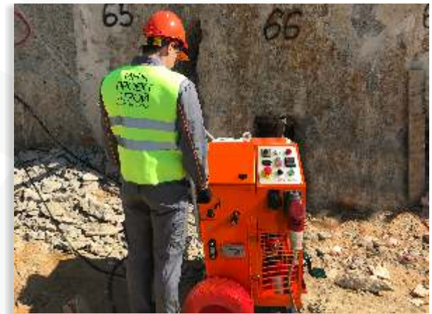
Hydraulic station Jack 2E
